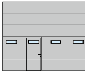
SPU F42, SPU 67 Thermo Panel con ventana tipo D Disposición de la puerta peatonal incorporada a la izquierda
